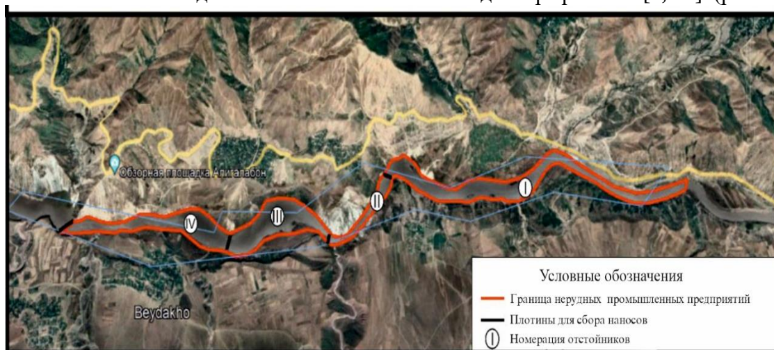
Рисунок 16. - Конструктивные и технологические мероприятия по борьбе с заиливанием Рогунского водохранилища.
